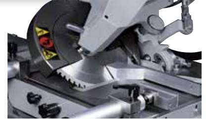
■ bis 45° neigbarer Kopf für Schifter-Schnitte
